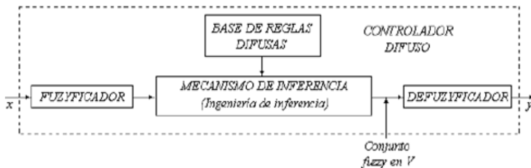
Fig. 3. Componentes de una Máquina de inferencia Difusa
