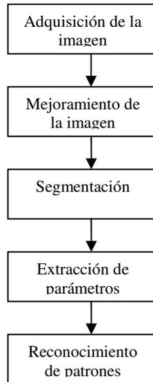
**Fig. 2.** Diagrama a bloques del sistema de reconocimiento
