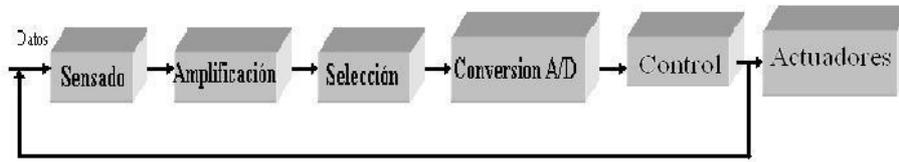
**Fig. 3.** Diagrama a bloques del Sistema de Control
