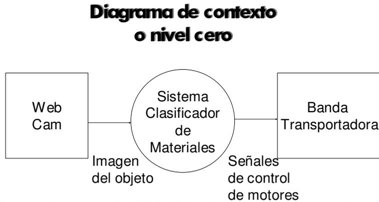
**Fig. 1.** Diagrama de contexto del SCM. Utilizará una WebCam para tomar la imagen del objeto, la cual se procesará y analizará en la PC, posteriormente la banda transportadora y las implementaciones necesarias realizarán la clasificación
