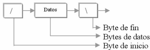
**Fig. 6. Protocolo de comunicación**
