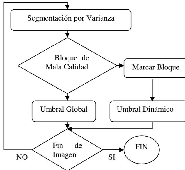
Fig. 2. Algoritmo propuesto denominado umbralización compuesta
