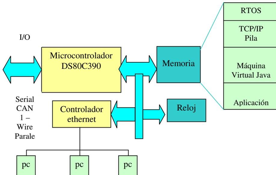
Fig. 1. Diagrama de la plataforma TINI
