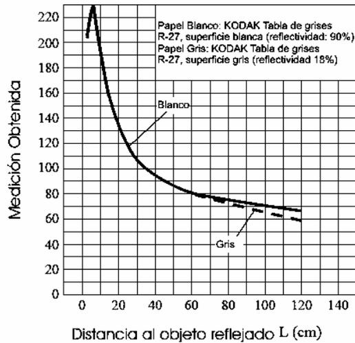
**Fig. 5.** Gráfica de medición del sensor infrarrojo, el eje vertical representa el número digital que retorna el sensor
