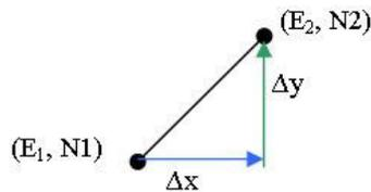
**Fig. 4.** Cálculo de  $\Delta x$  y  $\Delta y$
