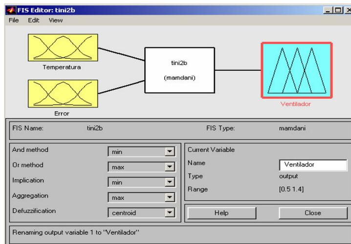
**Fig. 5.** Variables de entrada y salida utilizando Matlab
