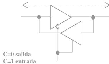
**Fig. 3. Arreglo de Buffers**
