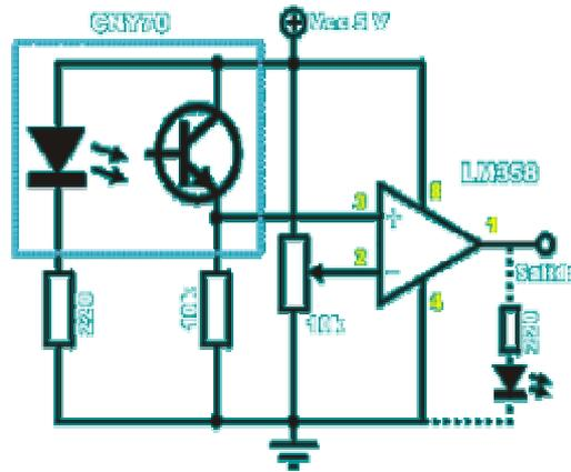
**Fig. 10.** Configuración del CNY70
