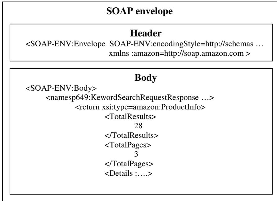
**Fig. 8.** Estructura de un mensaje SOAP
