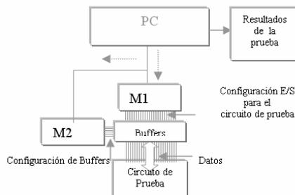
**Fig. 10.** Bloques de la verificación de un circuito
