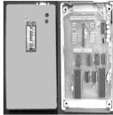
**Fig. 7. Verificador de Circuitos lógicos.**
