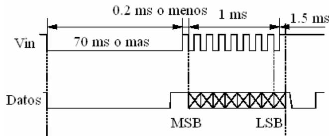
**Fig. 6.** Gráfica de tiempos del sensor infrarrojo.
